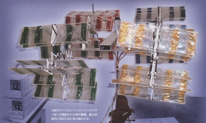
4翅のサイクロロジャイロ(パンタグラフ型)が連結された飛行機構造。翼は効率的に飛ぶために伸び縮みする。
