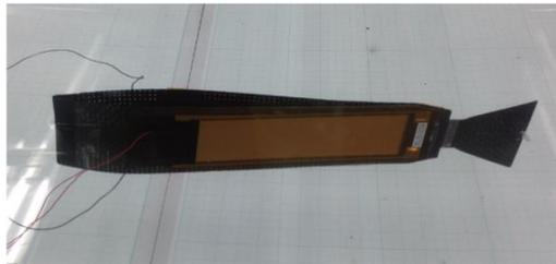
図 17 試作した中空型水中ロボット
