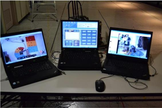
図5 ロボットアームを操作するために構築されたシステム。カメラ2台からの映像で死角をなくしている。
