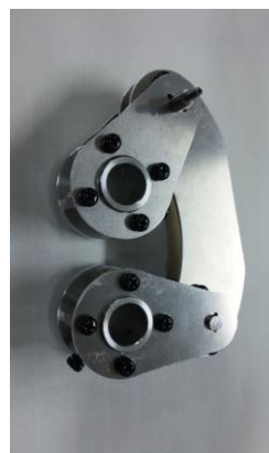
図2 リンク型変減速機構の試作機
