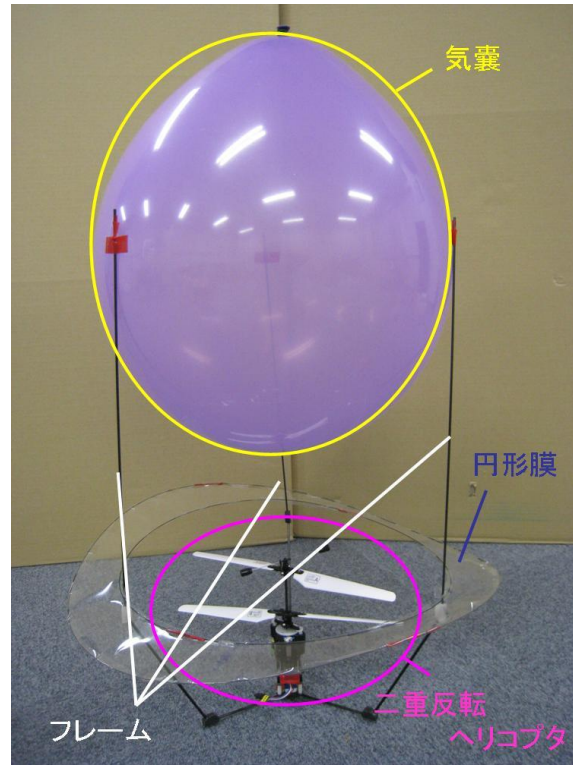
Fig.1: パッシブ姿勢安定化機構を搭載した飛行ロボット
