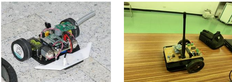
図 6 オリジナル移動ロボット:VPN を利用した仮想プライベートネットワークを構成し、インターネット経由で遠隔制御可能である。AR.DRONE によるキャプチャリング時間を計測可能となっている。
