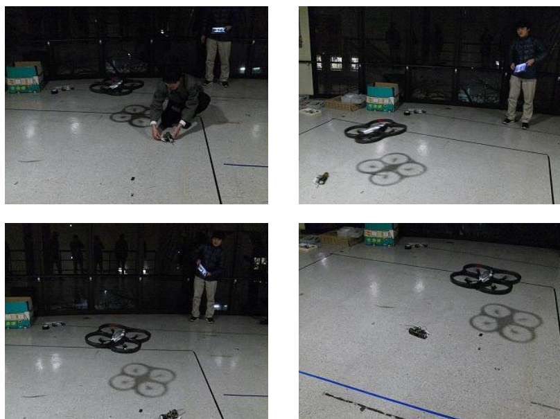
図 7 AR.DRONE およびトラックロボをそれぞれの大学側のグループがチームを構成し、インターネット遠隔制御により協調動作をさせることに成功している。その際の作業は俯瞰位置に設定したカメラと機体に搭載されたカメラの画像を確認しているがインターネットの遅延時間があるため、制御コマンドを生成するだけでなく、予測不能な状況にも相互連絡で対応することが余儀なくされている。
