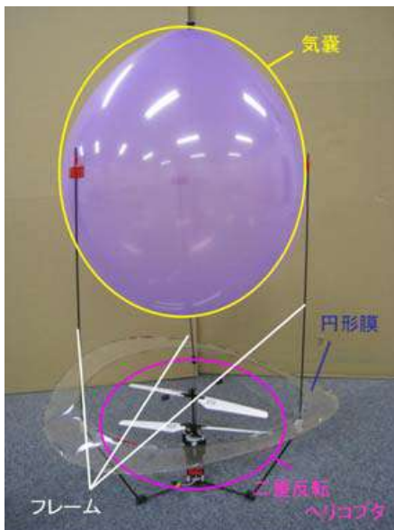
Fig. 3 : パッシブ姿勢安定化機構を備えた 同軸二重反転型ヘリコプタ
