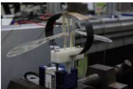
図 16 リング型モジュールとクリック機構による羽ばたきロボット
