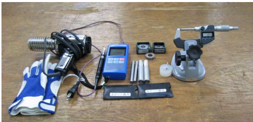
図 5.2.4 実習 1 で使用するマイクロメータ，温度計，リングゲージ，シャフトなど
