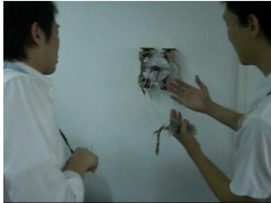
図 3-1.10 吸引移動ロボット
