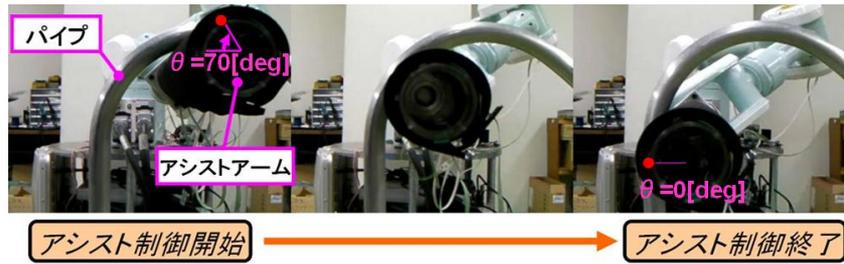
図 13: 前後屈動作のアシスト制御実験の様子
