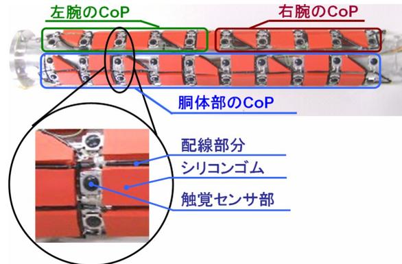
図 10: アシストアームに装着するセンサモジュール
