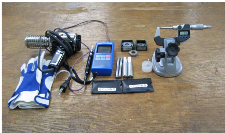
図 5.2.4 実習 1 で使用するマイクロメータ, 温度計, リングゲージ, シャフトなど
