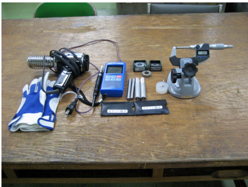
図 5.2.5 実習 1 で使用したマイクロメータ，温度計，リングゲージ，シャフトなど
