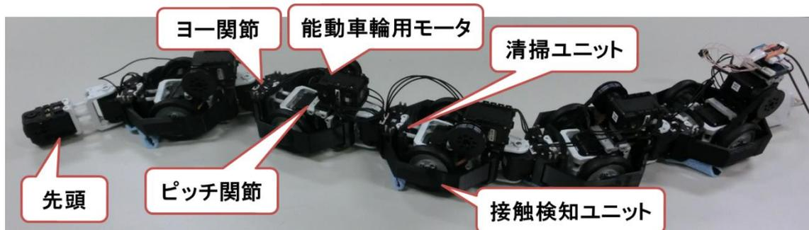
Fig.2: 多連結清掃ロボット
