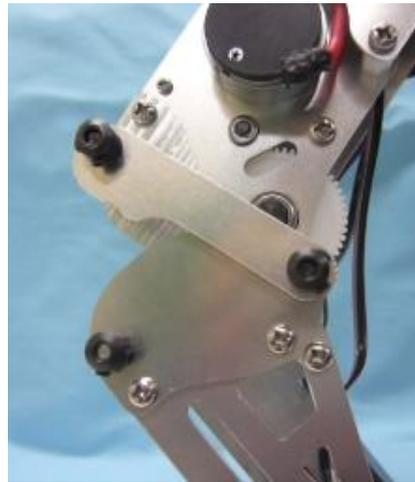
図 2.6 ロボット本体と膝関節側面図
