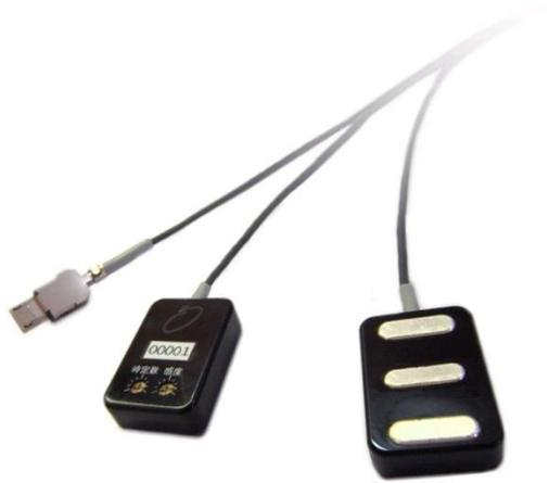
Fig.10: 表面筋電センサ(乾式3極タイプ)
